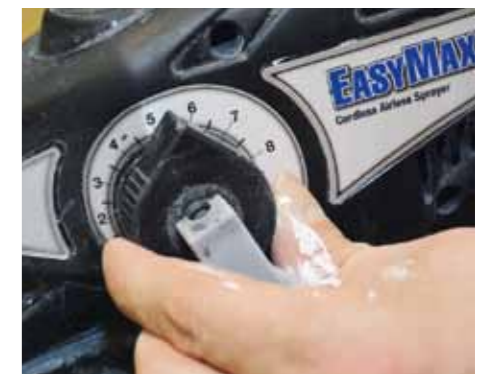
Mit dem ProControl-Knopf für die stufenlose Druckregelung kann man feiner spritzen und den Beschichtungsstoff besser dosieren. Das Füllventil dient dem schnellen Befüllen und Druckablassen
