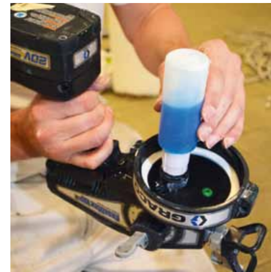
Mehrmaliges Durchspülen mit der Reinigungsflüssigkeit Pump Armor hält die mechanischen Komponenten beweglich, schützt vor Korrosion und dient als Frostschutz
