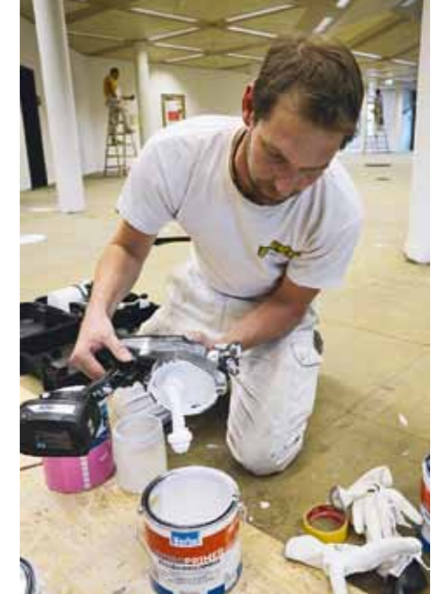
Das flexible Ansaugrohr unterstützt das optimale Ansaugen des Beschichtungsstoffes aus dem Behälter
